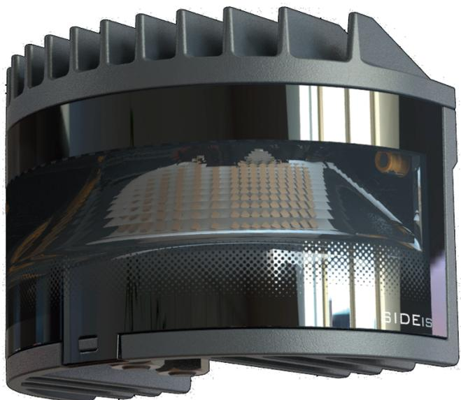
SIDEis è progettato intorno al suo gruppo ottico brevettato, costituito da una guida di luce polimerica trasparente, stampata ad iniezione, e da una PCB multi-sorgente.
